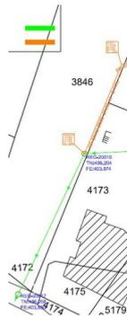
A cet effet, l'ATMB propose à Annemasse Agglo, la constitution d'une servitude d'écoulement des eaux et donc un droit de passage de canalisations souterraines des eaux pluviales et usées (diamètre 500 mm en polypropylène avec présence d'un regard diamètre 1000 mm).
