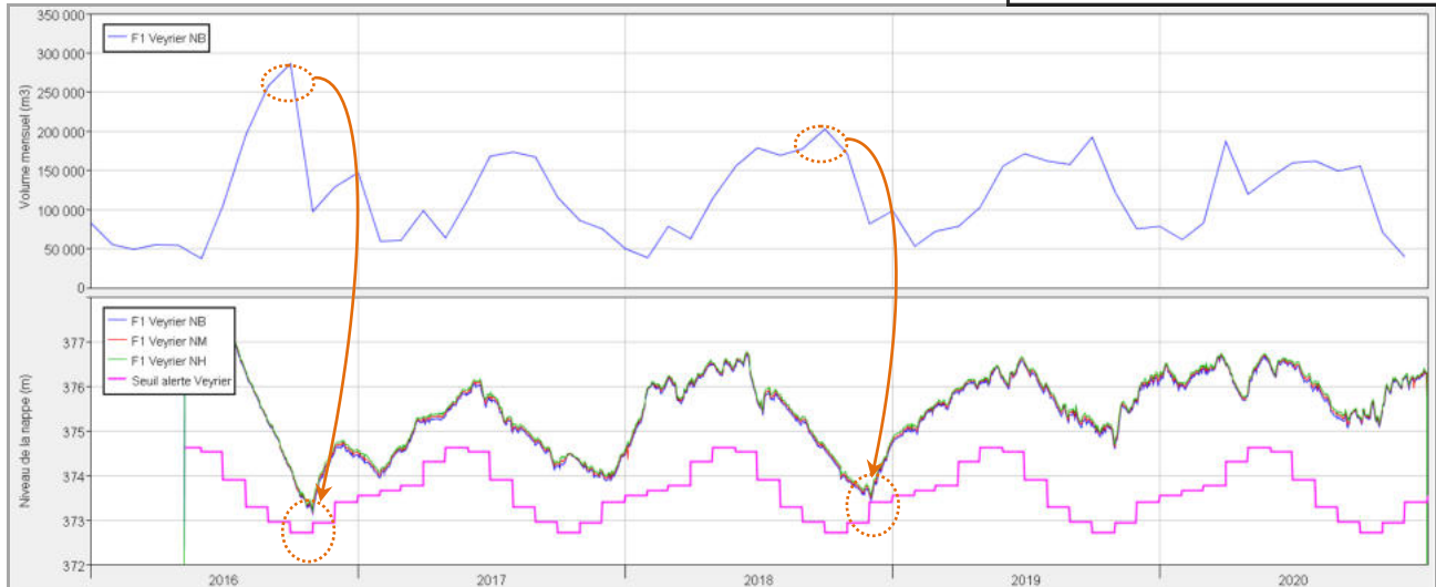
Figure 41 : Evolution de niveau de la nappe Genevois et les prélèvements au niveau du forage F1 de Veyrier
