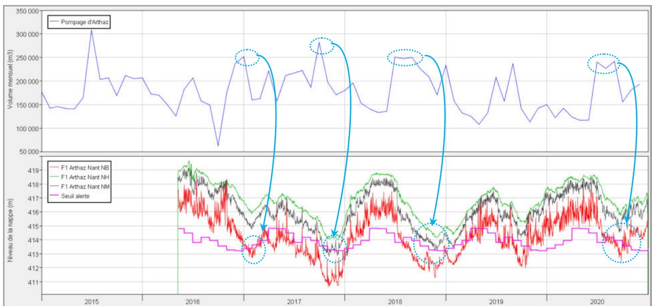
Figure 42 : Evolution de niveau de la nappe Basse Vallée de l'Arve à Arthaz et les prélèvements au niveau des forages de Nant
