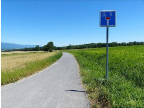
En jouant sur le plan de circulation ou en utilisant la configuration naturelle des axes, il est possible de guider les cyclistes vers des rues en impasse qui offrent une perméabilité aux cyclistes et piétons. Ces axes ne recevant qu'un trafic routier limité aux riverains, elles se révèlent être sûres et attractives pour les cyclistes. Une phase de test peut être réalisée afin d'évaluer l'impact sur la circulation et l'acceptabilité par les usagers et riverains.
