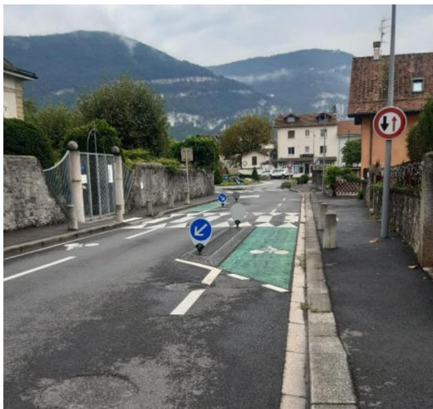
La largeur de la voie ouverte aux véhicules motorisés est insuffisante pour permettre le croisement, ces derniers empruntent donc la rive lorsqu'ils se croisent, en vérifiant auparavant l'absence de cyclistes.
