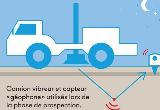
Camion vibreur et capteur «géophone» utilisés lors de la phase de prospection.
