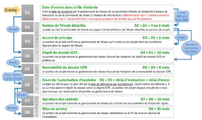
Une étude détaillée a été commandée à GRDF qui a confirmé la capacité du réseau public à absorber le débit de biogaz produit par l'UDEP Ocybèle (jalon D2). La mise en service de l'ouvrage d'injection (jalon D8) est prévue à fin 2024 dans le planning prévisionnel des travaux.
